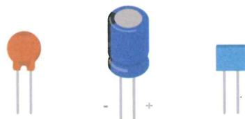
**Condensatori** - Questi componenti immagazzinano e rilasciano energia elettrica in un circuito. Quando la tensione del circuito è superiore di quella che viene immagazzinata nel condensatore, la corrente fluisce, dando una carica al condensatore. Quando la tensione del circuito è inferiore, la carica immagazzinata viene rilasciata. Spesso sono posizionati tra l'alimentazione e la massa vicino a un sensore o a un motore per compensare le fluttuazioni di tensione.
