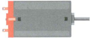
**Motore a corrente continua** - Converte l'energia elettrica in energia meccanica quando la corrente elettrica viene applicata ai suoi terminali. Gli avvolgimenti all'interno del motore vengono magnetizzati quando vi fluisce la corrente. Questi campi magnetici attraggono e respingono magneti permanenti facendo ruotare l'albero. Se la direzione della corrente viene invertita, il motore gira in senso opposto.
